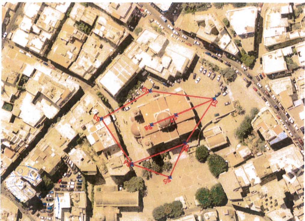
Εικόνα 1: Σκαρίφημα των κορυφών του πολυγωνομετρικού δικτύου.
